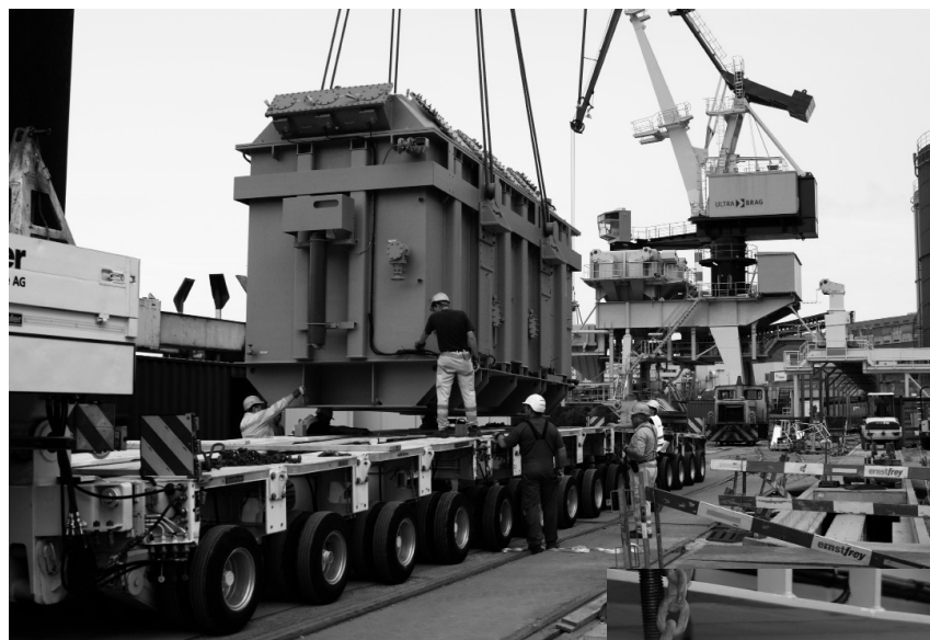
Oben: Verladen des Transformators auf den 15-achsigen Schwerlastanhänger der Transportfirma Welti-Furrer.
